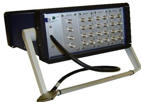
Figura 4. SpectraPad acquisizione dati front-end.
